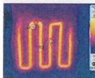
従来品 カーボンヒーター 線を温めるため 断線しやすい
